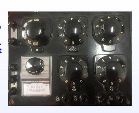
被测电阻=比例臂的比例系数×比较臂电阻
