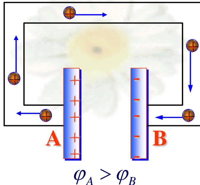
随着自由电荷的不断迁移，两导体上**电荷量逐渐减少**，
